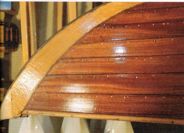
Ästhetik: Optisch sind Klinkerboote ein Genuss und eine Verbeugung vor der Bootsbaukunst. Jede einzelne Niete wird per Hand eingeschlagen, geschliffen, gebürstet.
