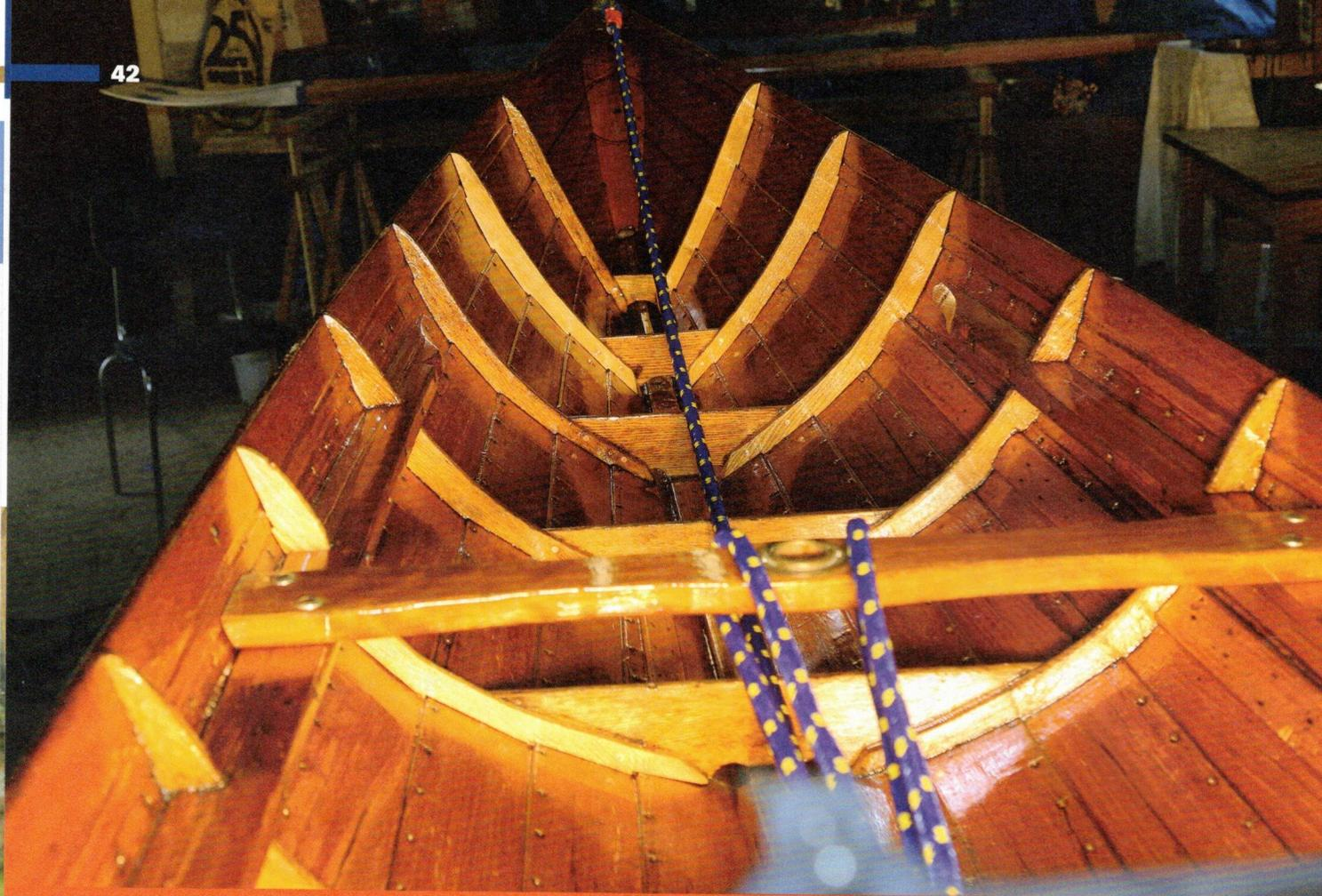
**Wertarbeit:** Rund 300 Stunden benötigt der alte Bootswart für die Generalüberholung eines Vierers. Dann ist aber auch jeder Spant, jede Bodenwange, jede Planke überprüft, repariert oder erneuert worden.
